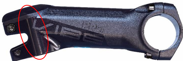
Obr. 2: V oblasti upnutí sloupku přední vidlice může dojít k prasknutí.
