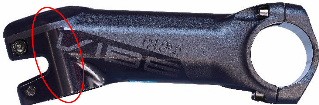
Joonis 2. Kahvlitorule kinnitatav klamber võib mõraneda
