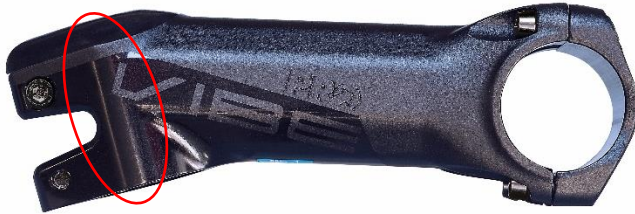
2. ábra: repedés alakulhat ki a villanyak csövet befogó területen.
