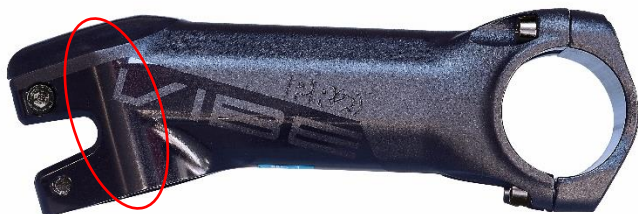
Obrázok 2: prasklina môže vzniknúť v oblasti upnutia rúrky riadenia vidlice.
